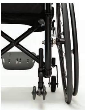
Carrossage réglable directement sur le fauteuil
