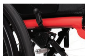
Freins traditionnels avec poignées rabattables (B40)
