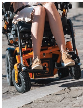
Palonnier articulé permettant de franchir des dénivelés et obstacles en gardant les 4 roues au sol
