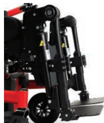
BZ8E ART - Repose-jambe électrique articulé auto-corrigeant en longueur, avec palette articulée
